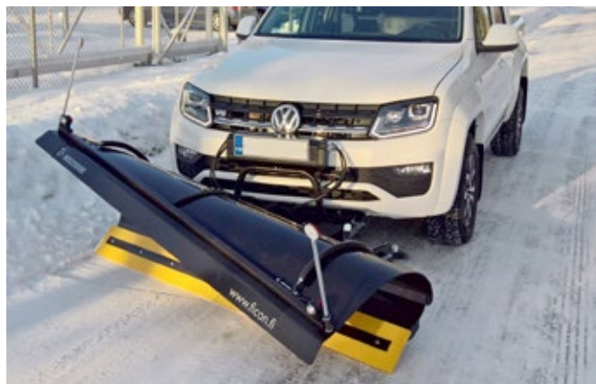
FC MS2500E muuttuvasiipinen heittävä lumiaura
